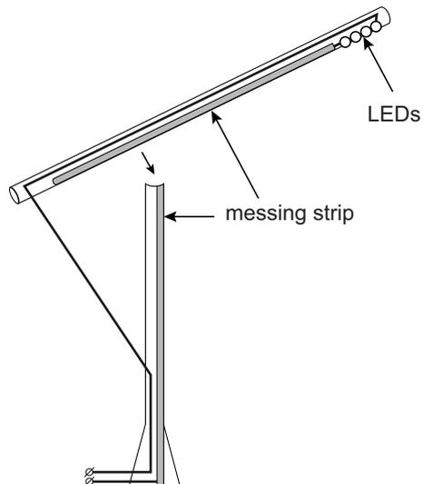
Langs het hout zitten strips van messing. Maken de twee strips contact dan gaat de lamp branden. Messing is een goede stroomgeleider.
